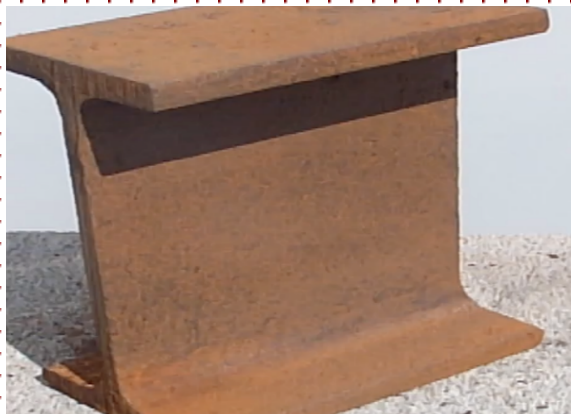
均一なサビの状態になれば 大体さび層は250μm以下にな ります
